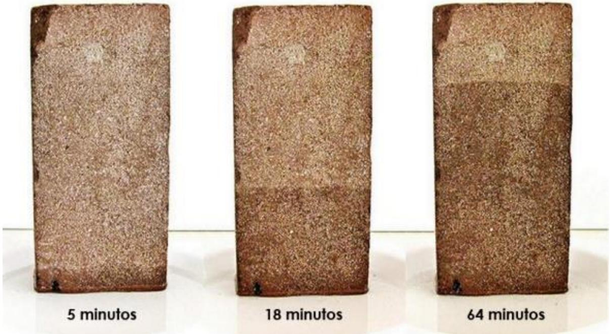
Una vez que la humedad llega al nivel del piso de la construcción sigue ascendiendo por las paredes y al tener contacto con el medio ambiente, con los cambios de temperatura el agua se evapora en la parte más alta que ha alcanzado. Y las sales que ha acarreado consigo desde el subsuelo, se cristalizan formando el salitre, el cual con el tiempo va explotando aplanados y muros internos, hasta un punto en que se desmoronan con solo pasar un dedo sobre ellos.
